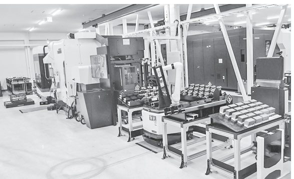
複合加工機へのワーク着脱をAMRで自動化 y DM G MOR
