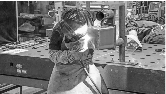
高水圧にも耐える正確でキレイな溶接が求められる
