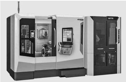
NTX500+機内走行式ロボットシステム IMTR
