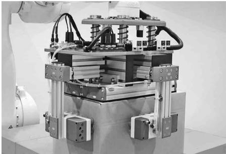
多様な段ボールのデパレタイジングに最適な真空グリッパーシステム
